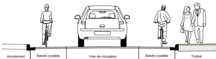
Conformément aux préconisations du schéma cyclable retenu sur la commune, une chaussée à voie centrale banalisée ou chaucidou sera matérialisée, offrant un espace pour les cyclistes. Un trottoir de 1,80 m à 2 m de largeur sera proposé sur la totalité et l'arrêt de bus « chemin de Devèzes » sera accessible aux personnes à mobilité réduite (PMR). Ces travaux conséquents doivent démarrer début septembre 2023 et se terminer en 2024.
